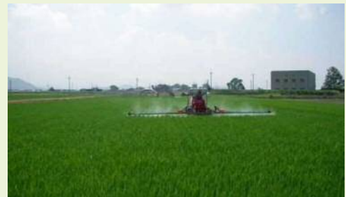
共同利用機械・施設整備事業で導入したブームスプレーヤーによる水稲防除
